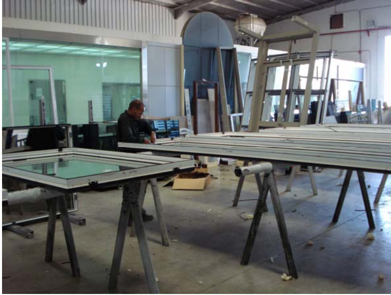
الشكل رقم (٩): نموذج لورشة ألنيوم لإنتاج النوافذ والأبواب.
