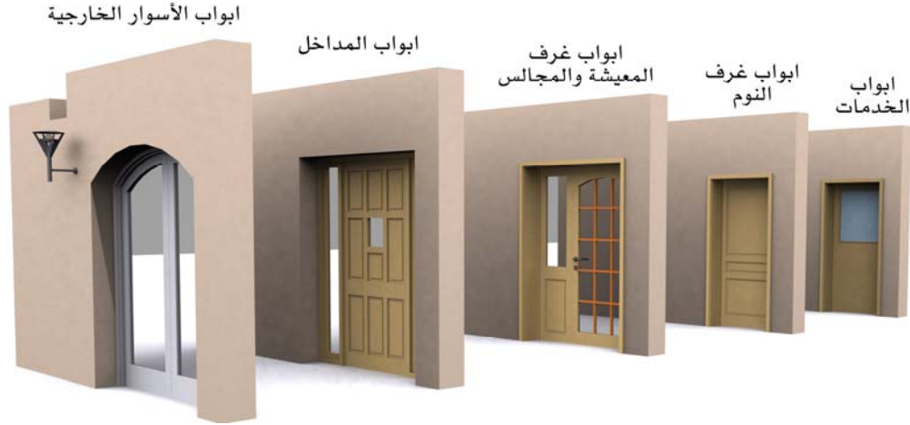
الشكل رقم (٢١): أنواع الأبواب التي يمكن إنتاجها بوصفها مكونات معيارية.
