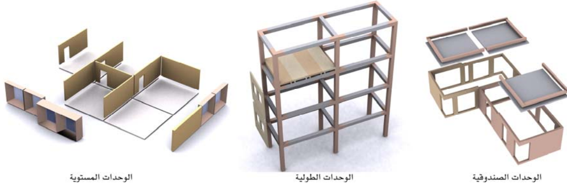
الشكل رقم (١٤): طرائق تصنيع المكونات الإنشائية المعيارية للوحدات السكنية.
